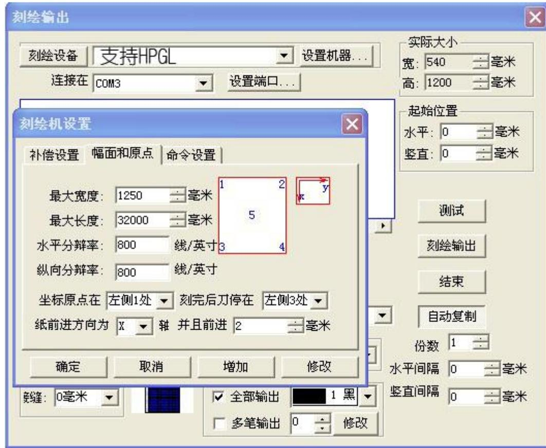
在割字機設置裏請將水平解析度和縱向解析度改為 800，舊板的機器是 1000.如果不改動數值會影響切割尺寸，並會出現因切割圖案尺寸過大而撞擊左側限位，造成機器停止切割。
