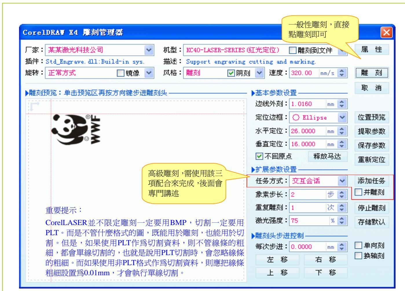
做好一個圖，加工一個圖，一個個來，這適合於一般性的雷射雕刻機用戶。但在某些應用場合，一般性的雕刻加工模式，可能會顯得效率較低，不適合於大量加工。一般性的雕刻加工模式，操作簡單，比較容易上手，而高級雕刻加工模式，可能還得琢磨一下才能上手。在CorelDRAW裏完成高級雕刻，是非常簡單的，因為一些相關細節，CorelLASER會協助用戶。
