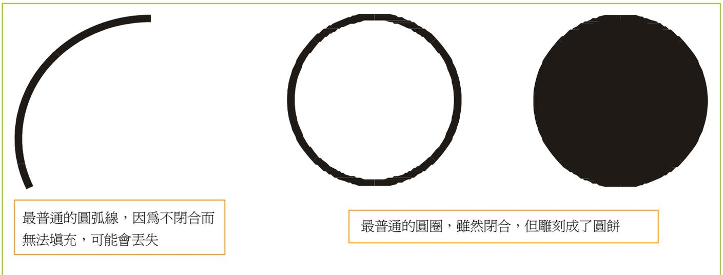
在所有圖都封閉的情況下，雕刻出來才可能是對的，但有多少圖形，全是由封閉的小圖組成的呢？尤其在很複雜的圖形中，誰能保證全是由封閉的小圖所組成的？在很複雜的圖形中，存在一段圓弧、一根線段、一根曲線，是再常見不過了。所以PLT是容易分色，但並不容易分層！難道不能把圖都設計成全是由封閉的小圖組成的圖嗎？當然可以，只要不嫌麻煩。如下圖，一根線段可設計成一個封閉的矩形，這比較容易，如果一段圓弧，一段奇形怪狀的曲線，也要變成封閉的，是不是太難了些？
